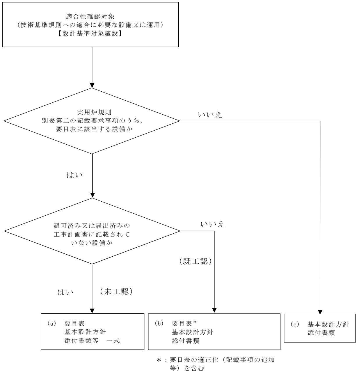
図3-7 適合性確認対象設備の本工事計画に記載する箇所の選定（設計基準対象施設）
