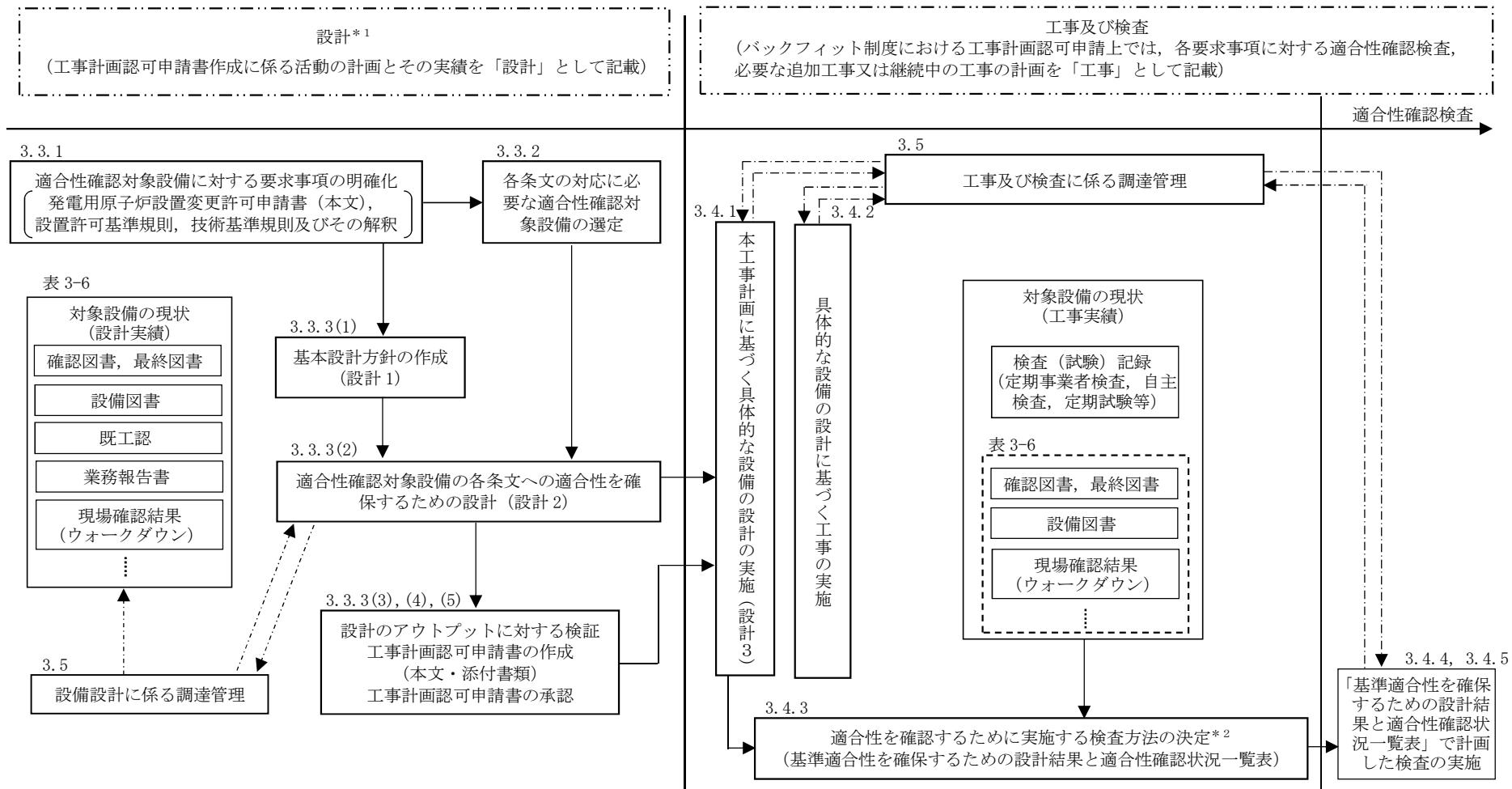
\*1: バックフィット制度における工事計画認可申請上の「設計」とは、要求事項を満足した設備とするための基本設計方針を作成（設計1）し、既に設置されている設備の状況を念頭に置きながら、適合性確認対象設備を各条文に適合させるための設計（設計2）を行う業務をいう。
