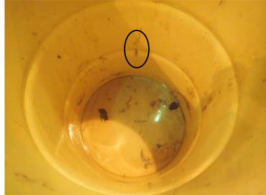
図4.ドラム缶底の様子（水分あり、溶接線部に腐食）
