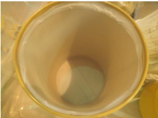
図5.インナー容器を設置した交換用ドラム缶
