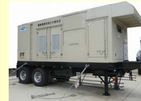
移動式発電機 (1000kVA) ※1
