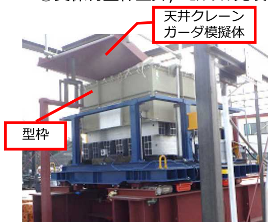
④支保材型枠上昇, モルタル充填
