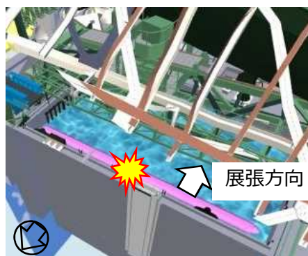
養生バッグ投入完了
