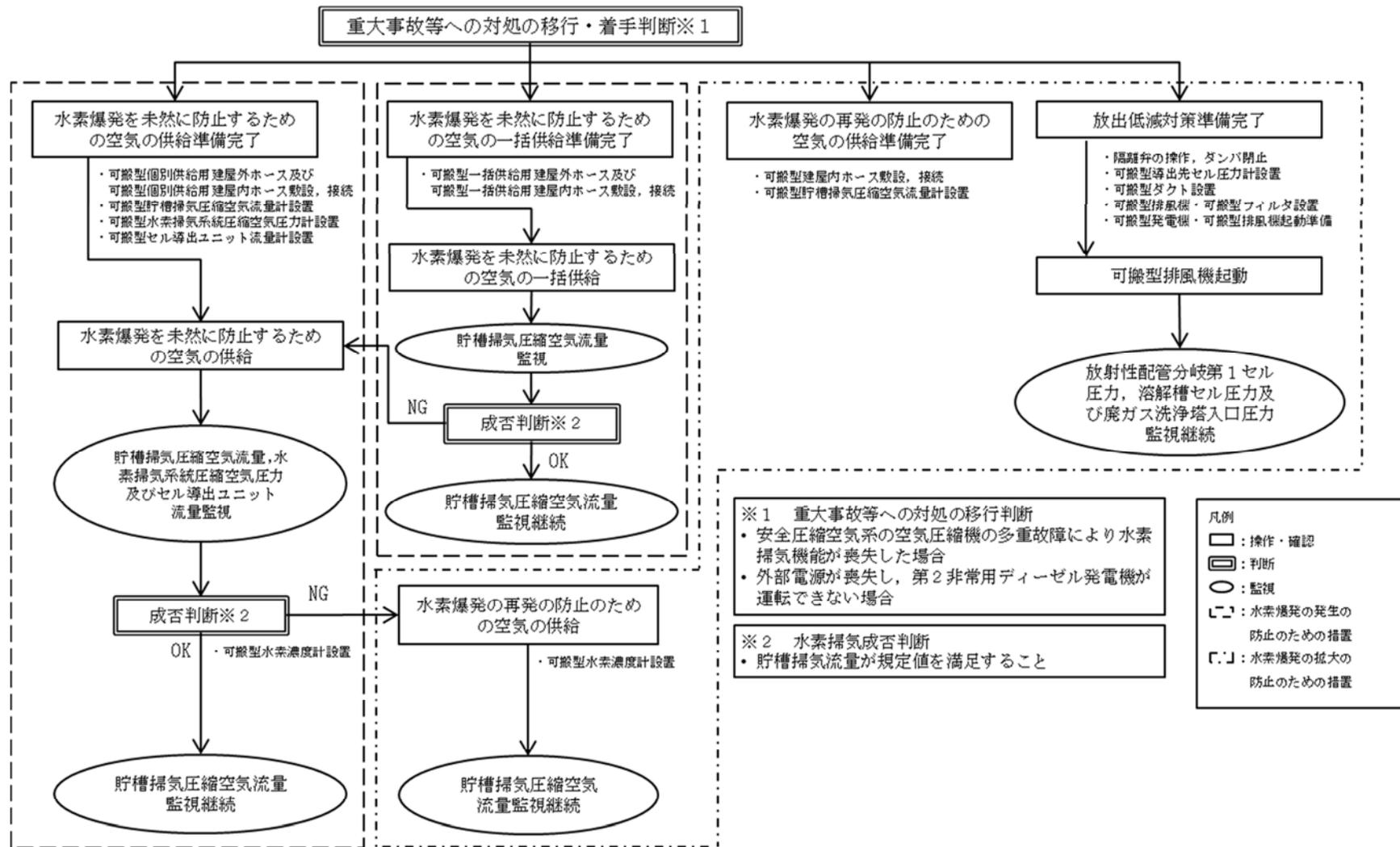
第 17 図 前処理建屋の水素爆発の発生及び拡大の防止のための措置の手順の概要
