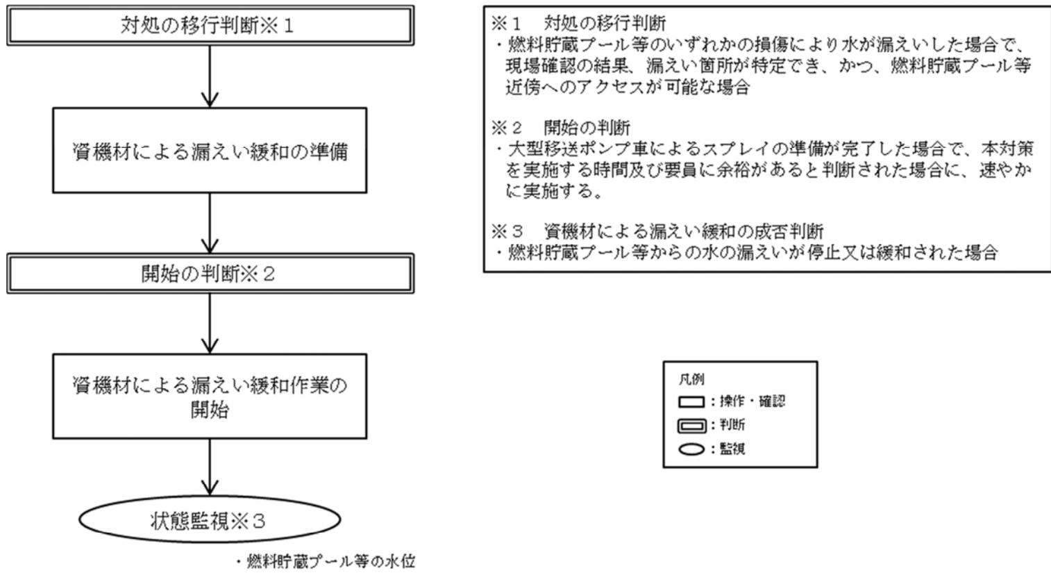
第 26 図 資機材による漏えい緩和の手順の概要
