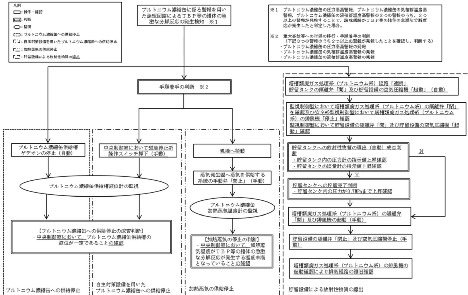
第 22 図 「精製建屋におけるプルトニウム精製設備のプルトニウム濃縮缶の T B P 等の錯体の急激な分解反応」 の手順の概要
