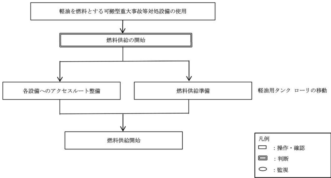
第 32 図 「燃料供給」 の手順の概要
