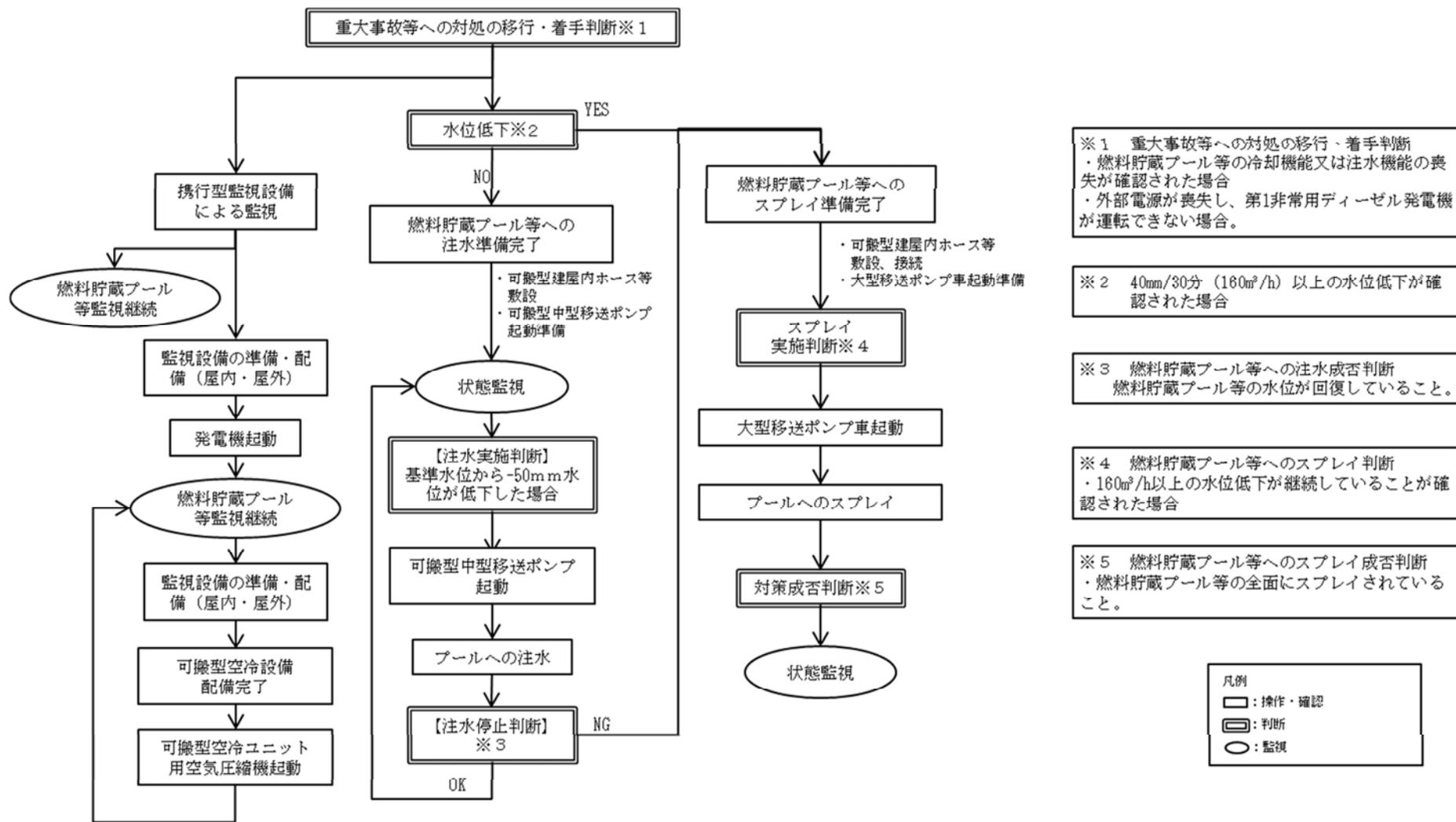
第23図 「燃料貯蔵プール等の冷却等の機能喪失」の手順の概要
