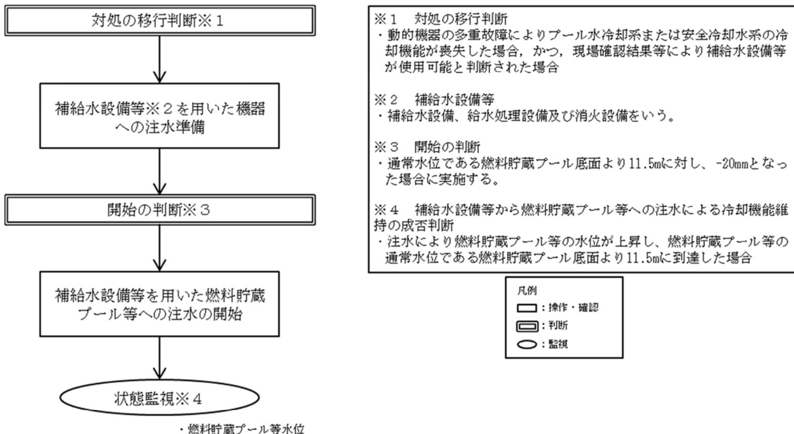
第25図 補給水設備等から機器への注水の手順の概要
