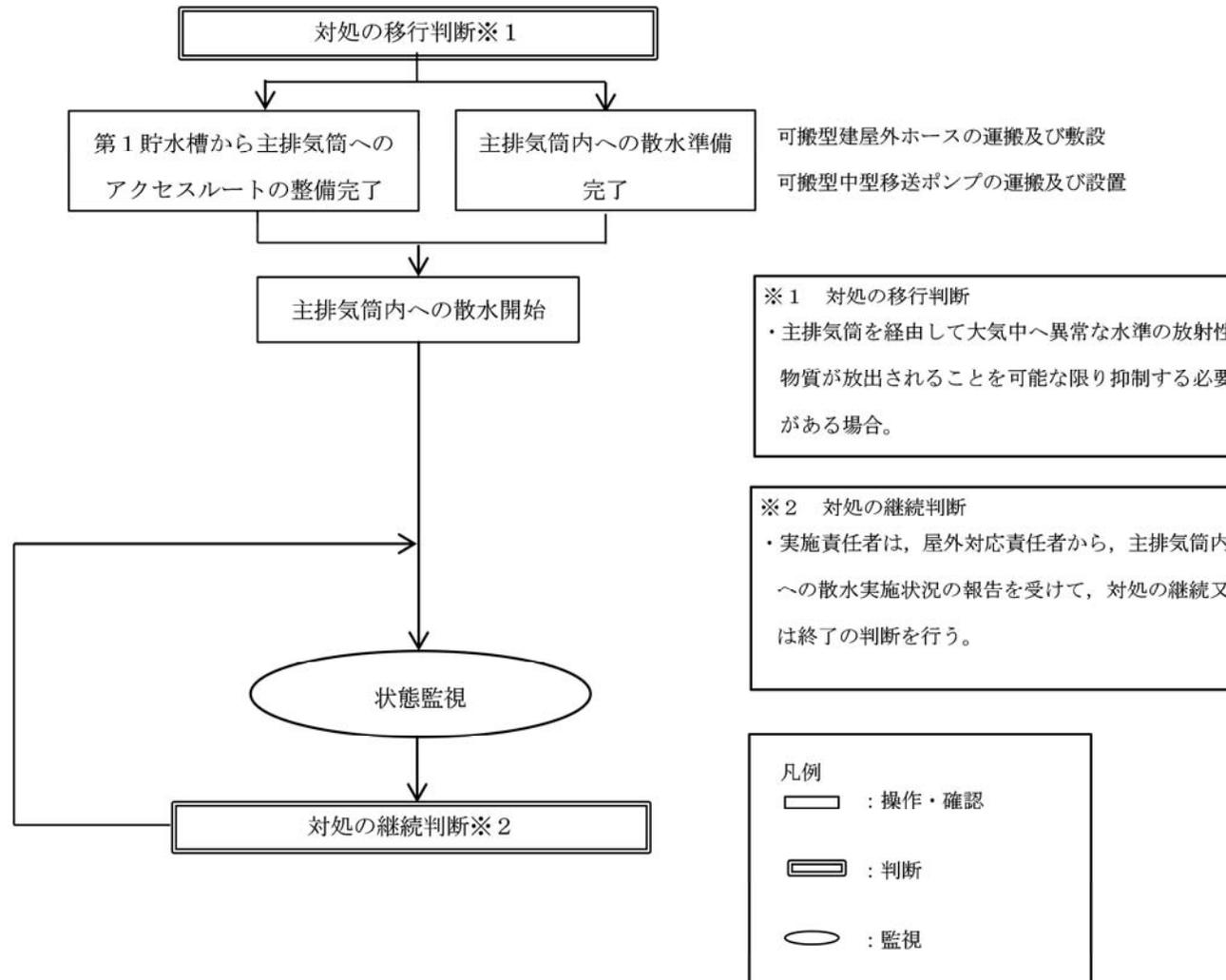
第 29 図 「主排気筒内への散水」の手順の概要
