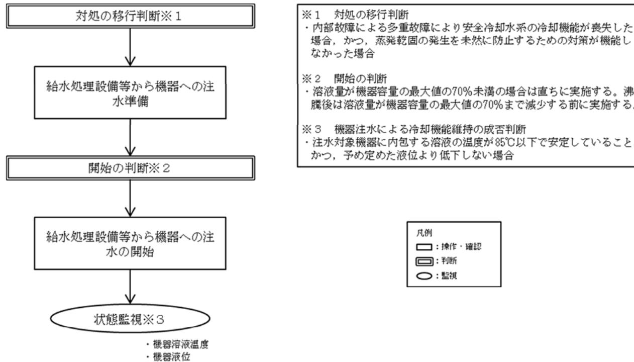
第 16 図 給水処理設備等から機器への注水の手順の概要
