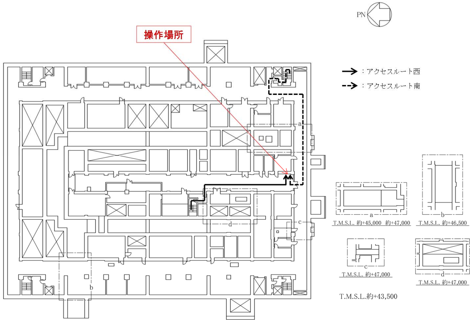
精製建屋 T B P 等の錯体の急激な分解反応の拡大の防止のための措置のアクセスルート (地下2階) (加熱蒸気の供給停止)
