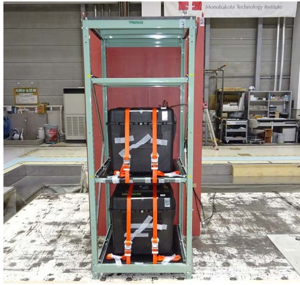
図8 可搬型水素濃度計の加振試験時の外観
