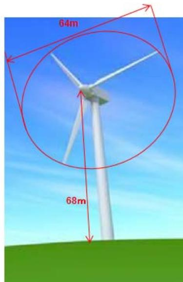
第5-3-1図 風力発電設備の寸法
