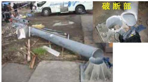
倒壊した道路標識支柱
