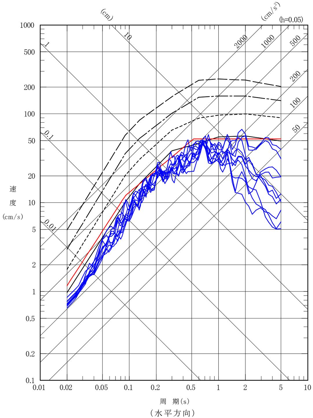
第 3 - 2 - 2 図(1) 地震ハザード評価結果
