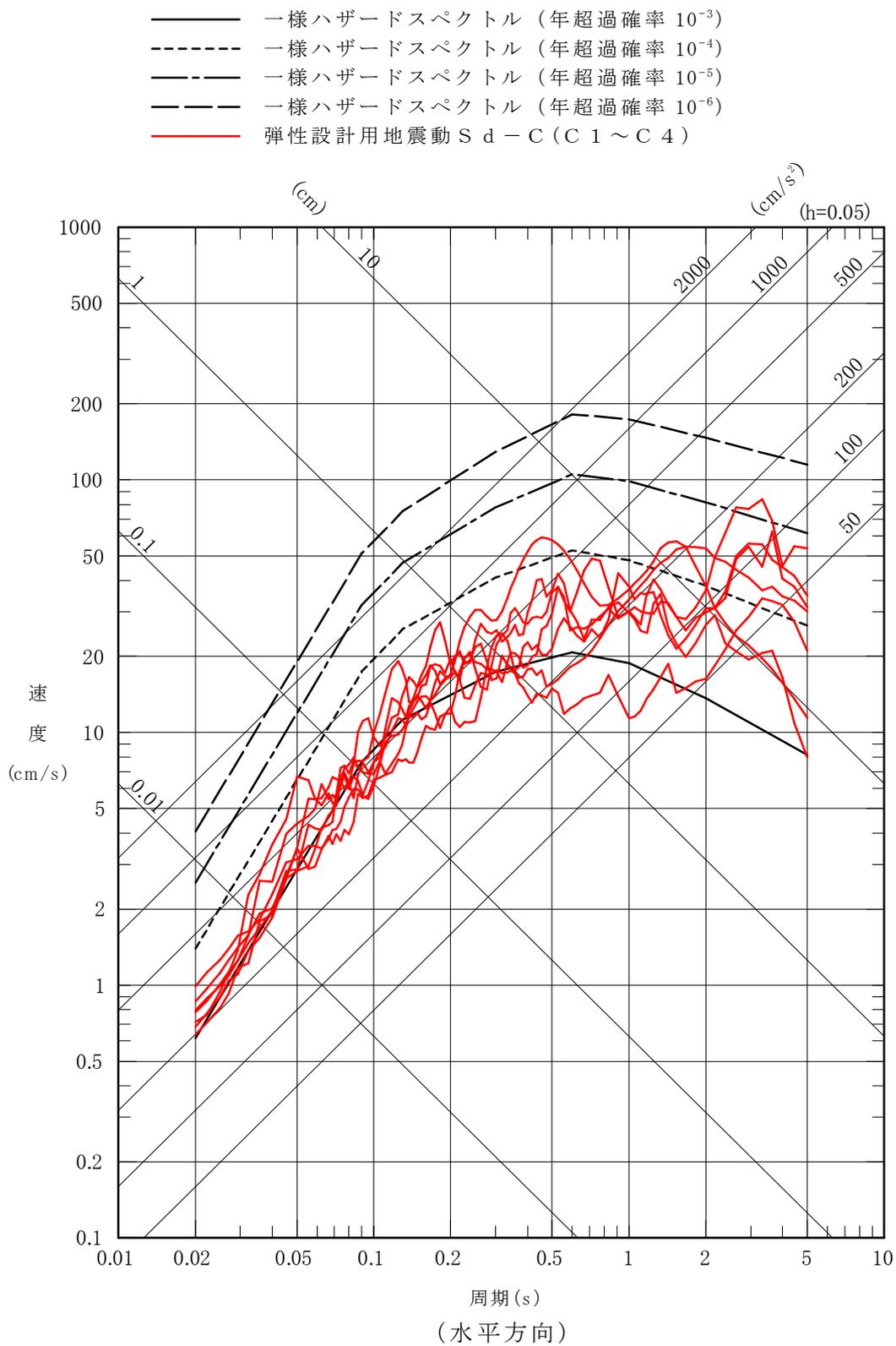
第 3 - 2 - 2 図 (3) 地震ハザード評価結果
