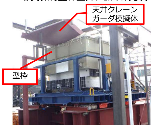
④支保材型枠上昇、モルタル充填
