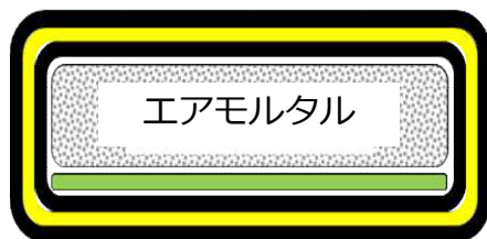
養生バッグ概略構造 (断面)
