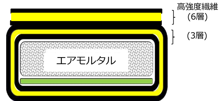
養生バッグ概略構造（断面）
