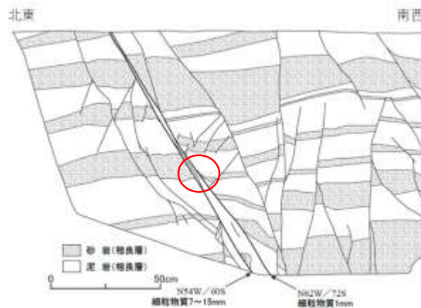
流動的な変形構造が乏しく、細粒物質を伴う断層に挟まれた区間の幅が狭いH断層の例 H-4断層 (40.5m盤(東側))
