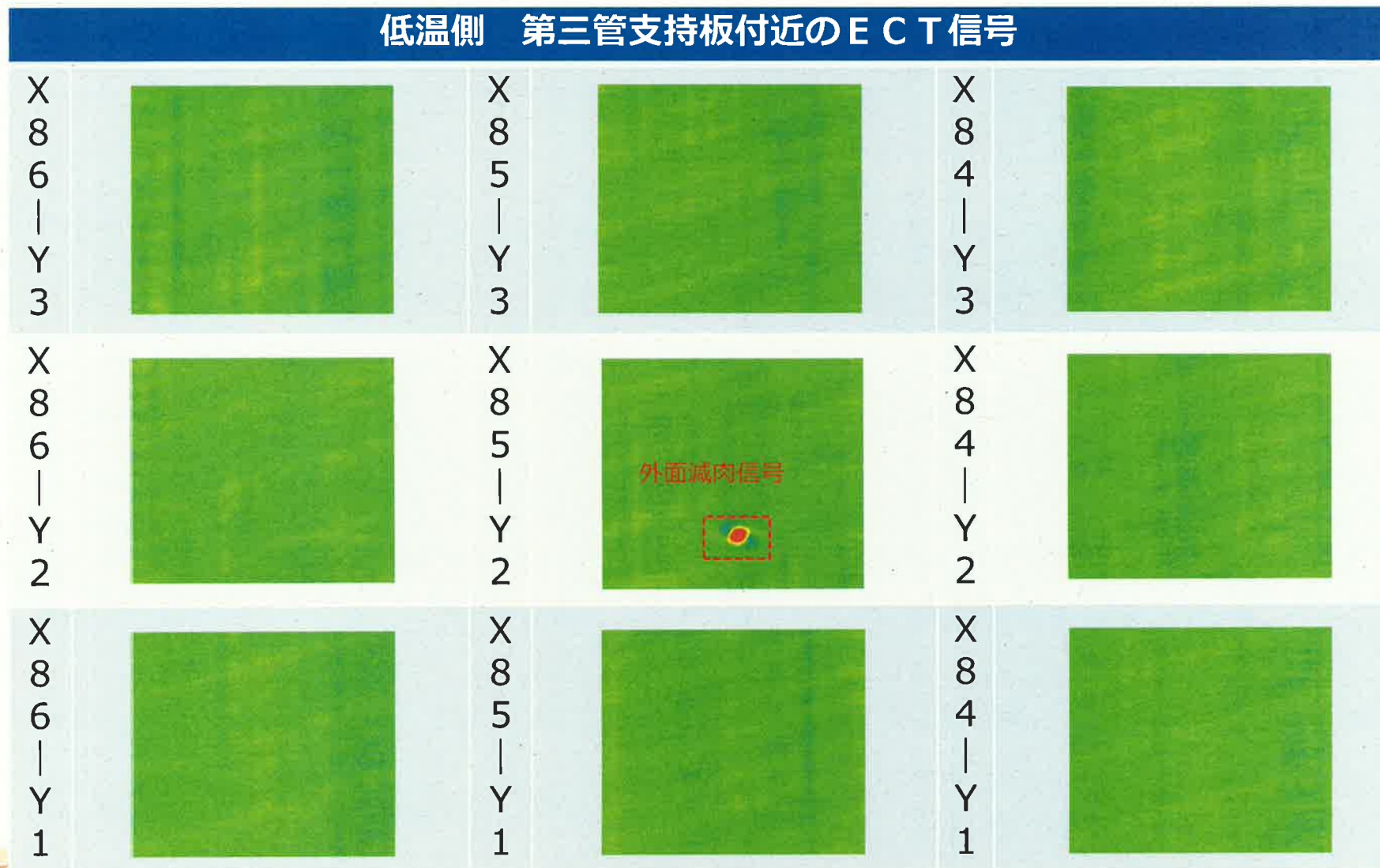
摩耗痕のある伝熱管と隣接した伝熱管のECT結果 (MIX : A - SGの例)
