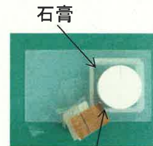
砥石 (接触角度①: 15°) 試験状況(上から)
