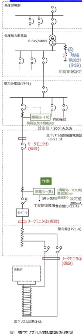
図 流下ノズル加熱装置系統図
