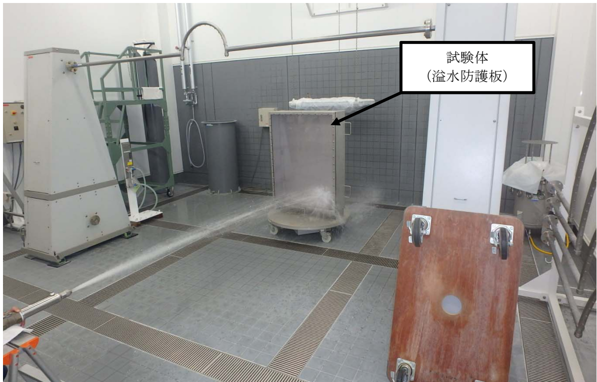
第2図 被水試験の例 (溢水防護板)
