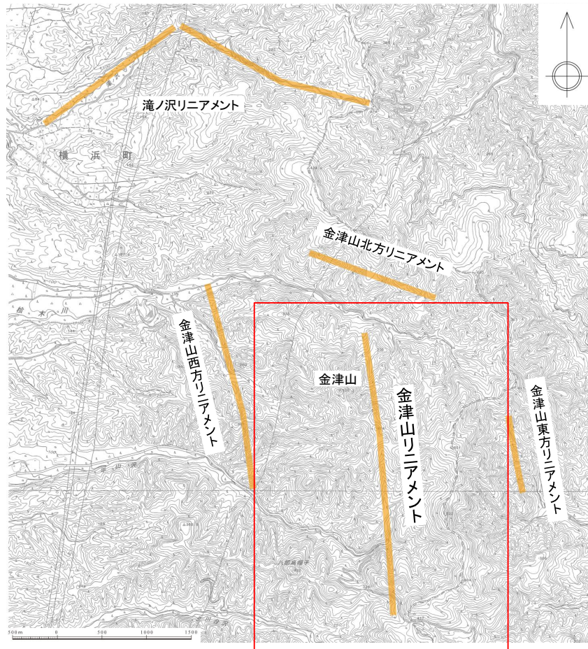
「[新編] 日本の活断層」(1991)による 活断層の疑のあるリニアメント(確実度Ⅲ)
