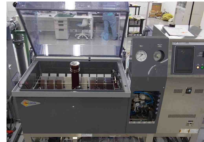
図6 劣化加速試験（予備試験）の状況
