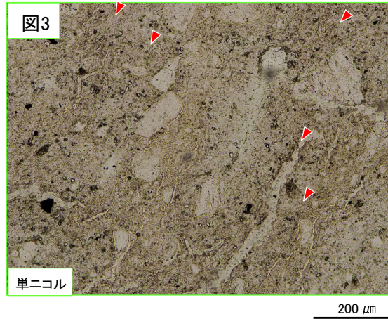
赤三角の方向は粘土鉱物の配列方向を示す
