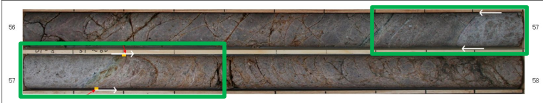
D-35破砕帯 H24-D1-3孔 深度56.88~57.24m
