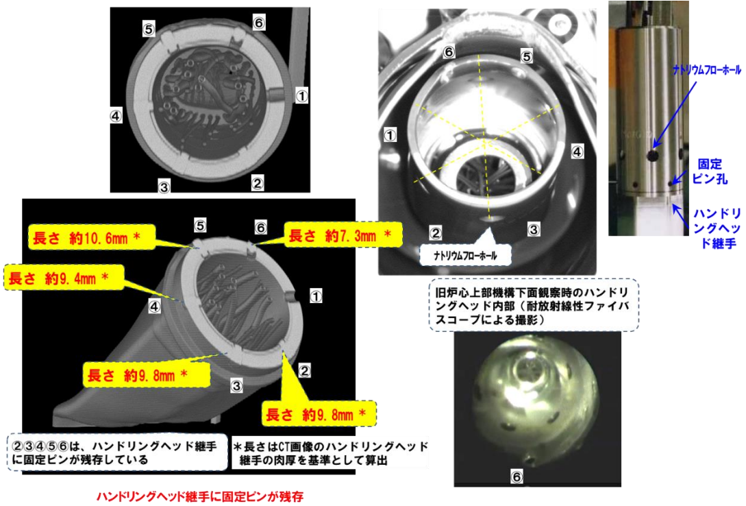
第 4.10 図 MARICO-2 試料部の X 線 CT 検査結果とハンドリングヘッド観察結果の突合せ
