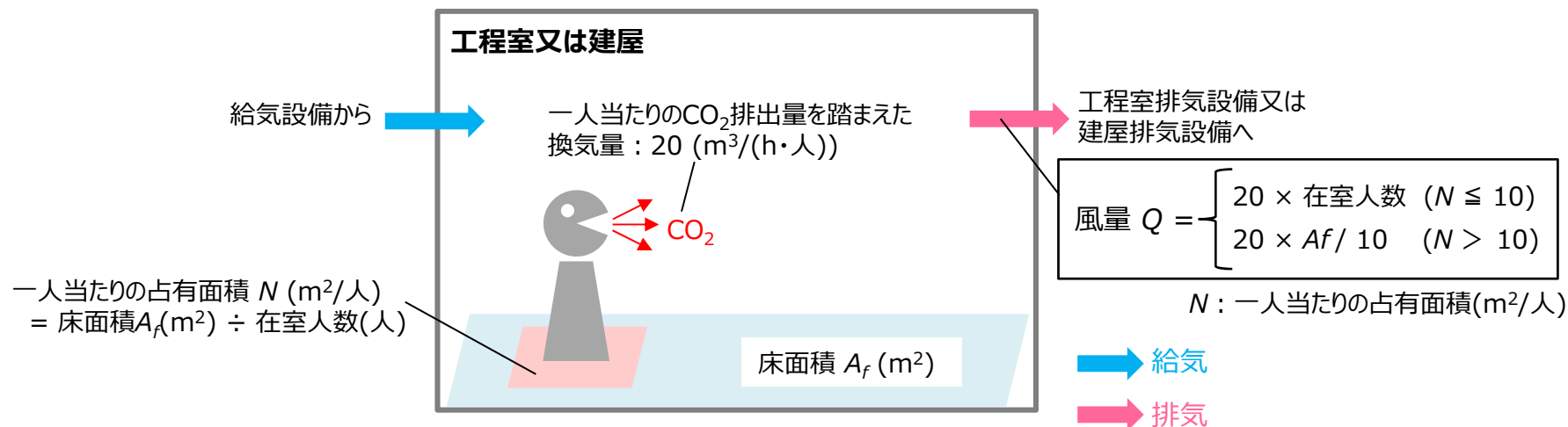
第1.1.6図 炭酸ガス濃度の抑制による風量設定のイメージ
