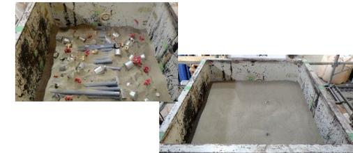
角型容器への砂充填試験例
