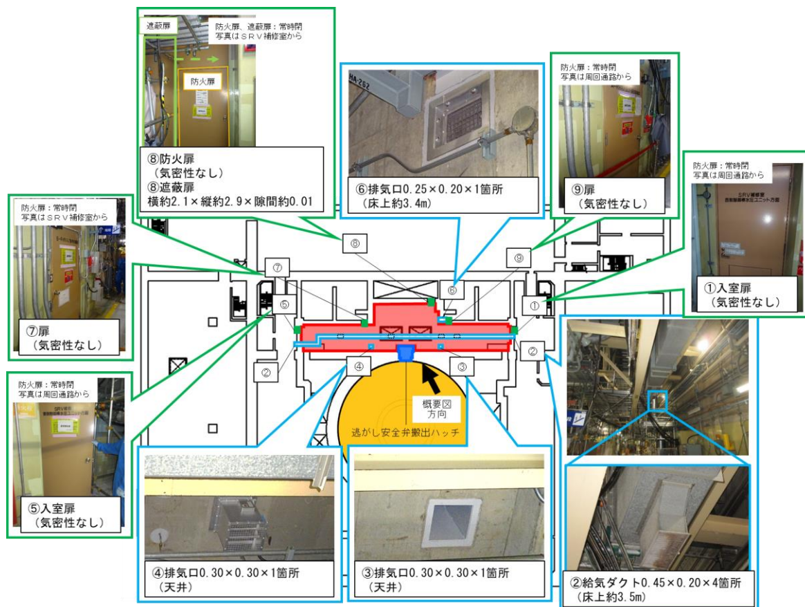
図 1.2 SRV補修室の開口部状況 (イメージ) (1/2)
