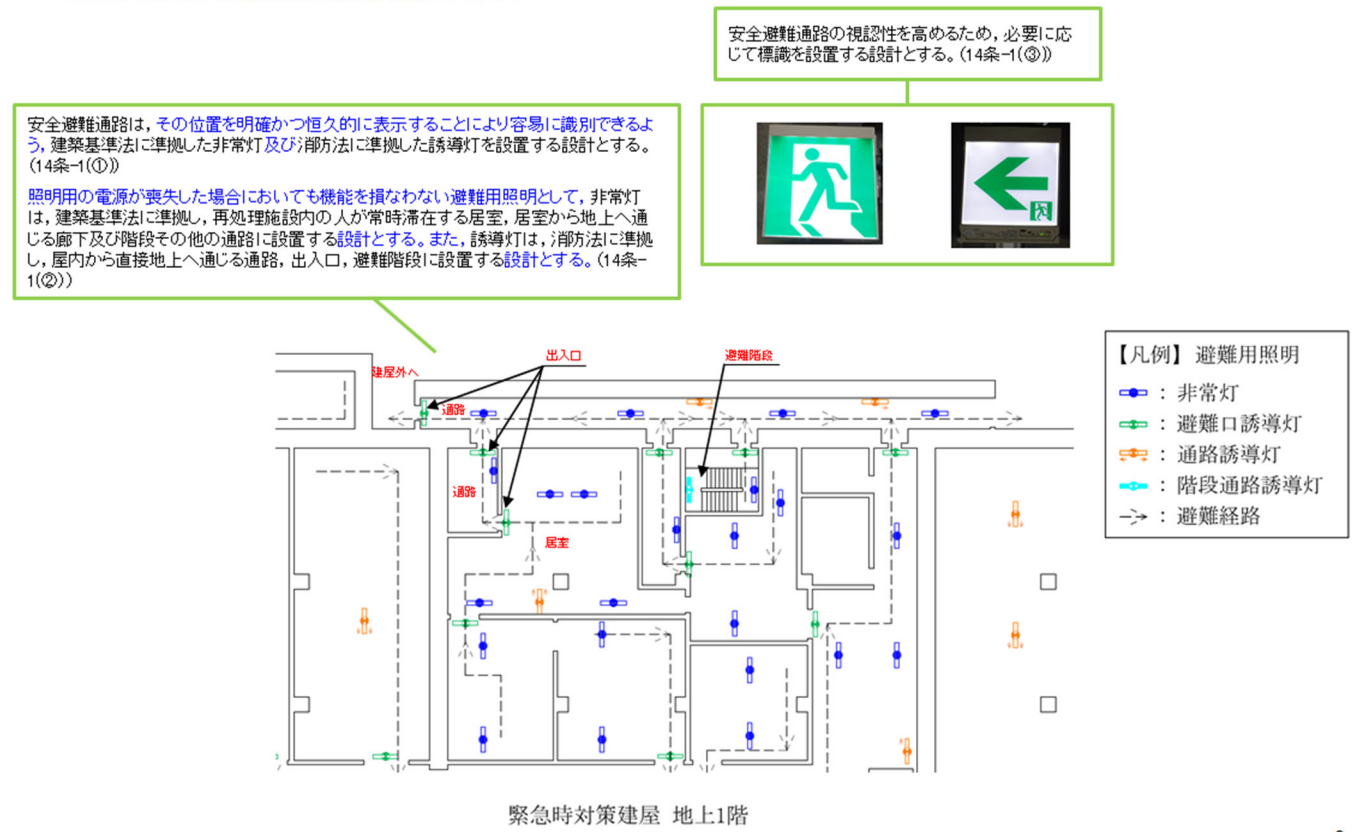
【安全避難通路, 避難用照明(誘導灯及び非常灯)】
