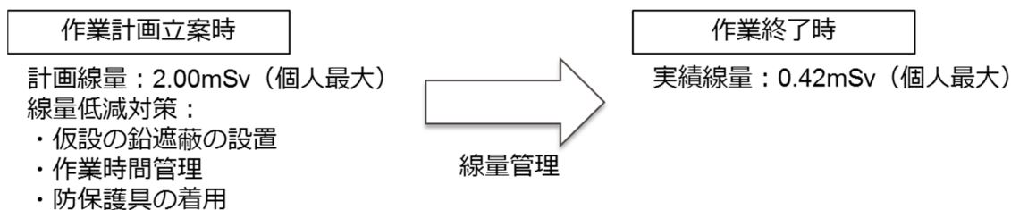
第20図 RCPインターナル除染作業での実績
