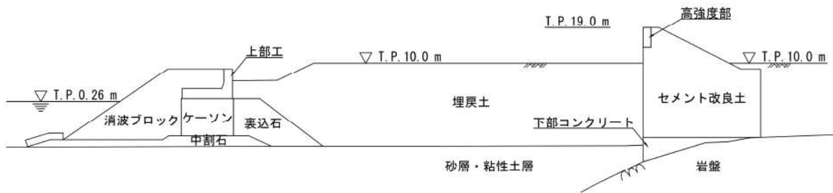
第 5-5 図 防潮堤（標準部）の横断図
