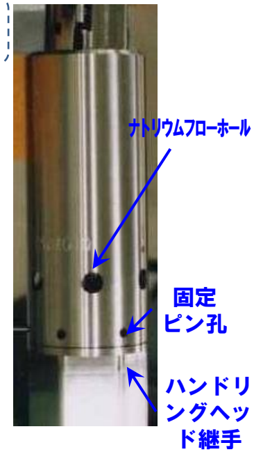
旧炉心上部機構引抜時に撮影したハンドリングヘッド（耐放射線性カメラによる撮影）
