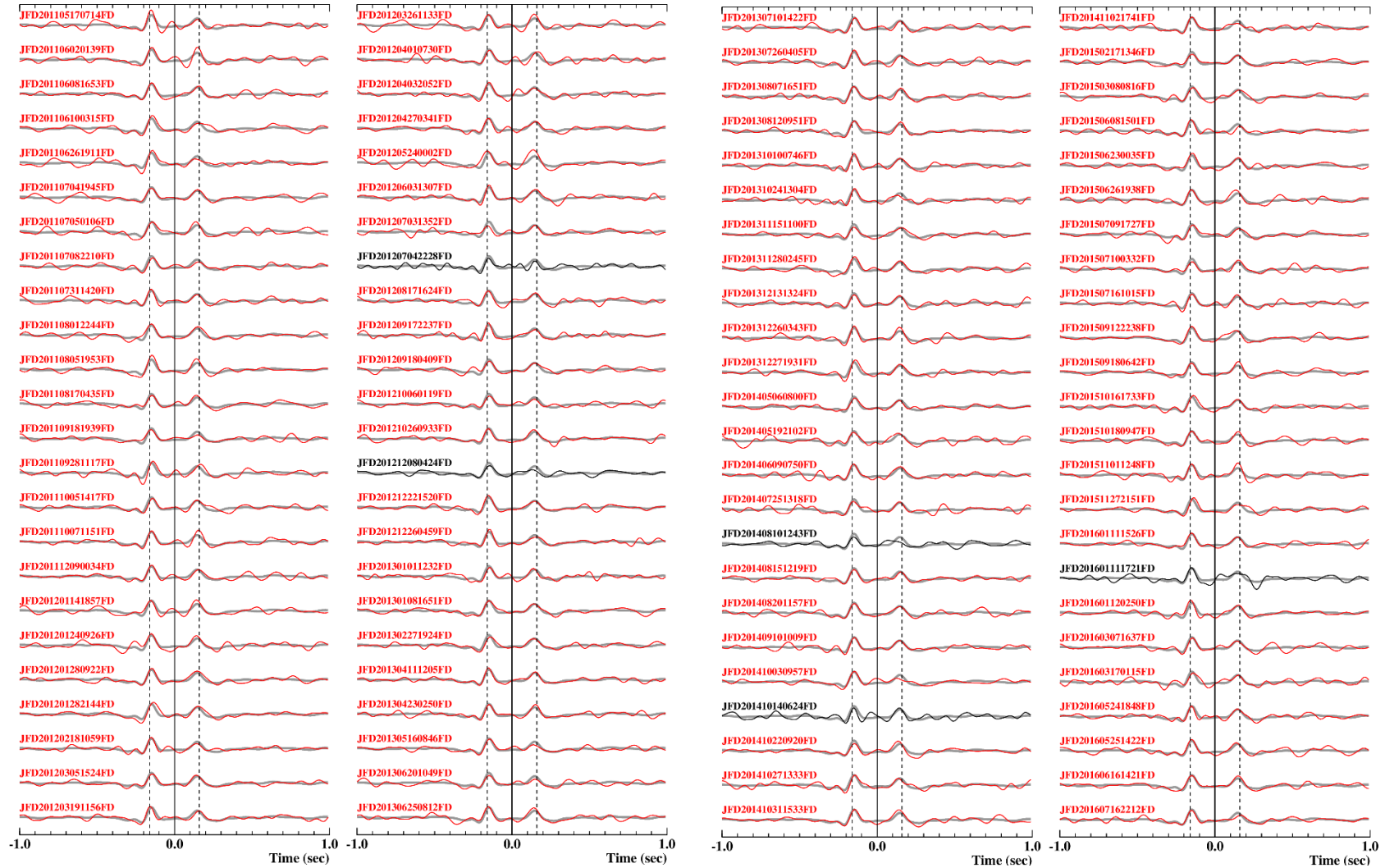
第4.5.2-2図 GL-2mに対するGL-125mの各地震のデコンボリューション波形（細線）とスタッキング波形（灰太線）（3/4）
