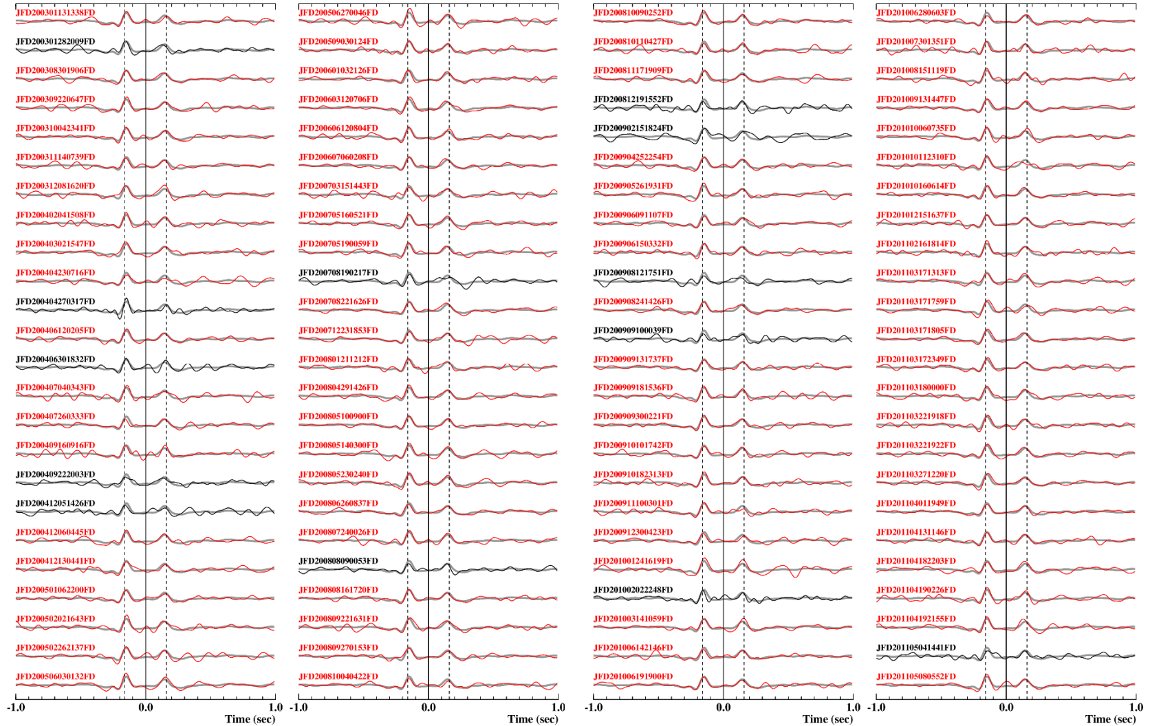
第4.5.2-2図 GL-2mに対するGL-125mの各地震のデコンボリューション波形（細線）とスタッキング波形（灰太線）（2/4）
