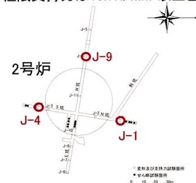
試掘坑内における支持力試験位置
