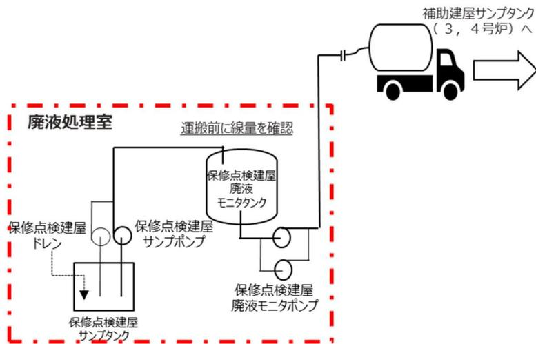
図1 液体廃棄物処理概略系統図
