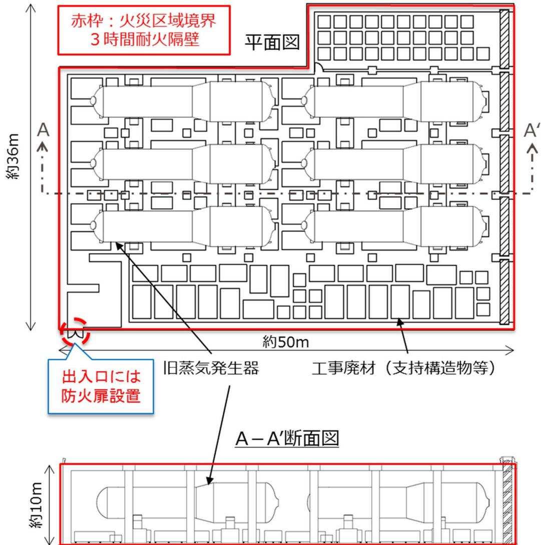
第 5-1-1 図 蒸気発生器保管庫の火災区域
