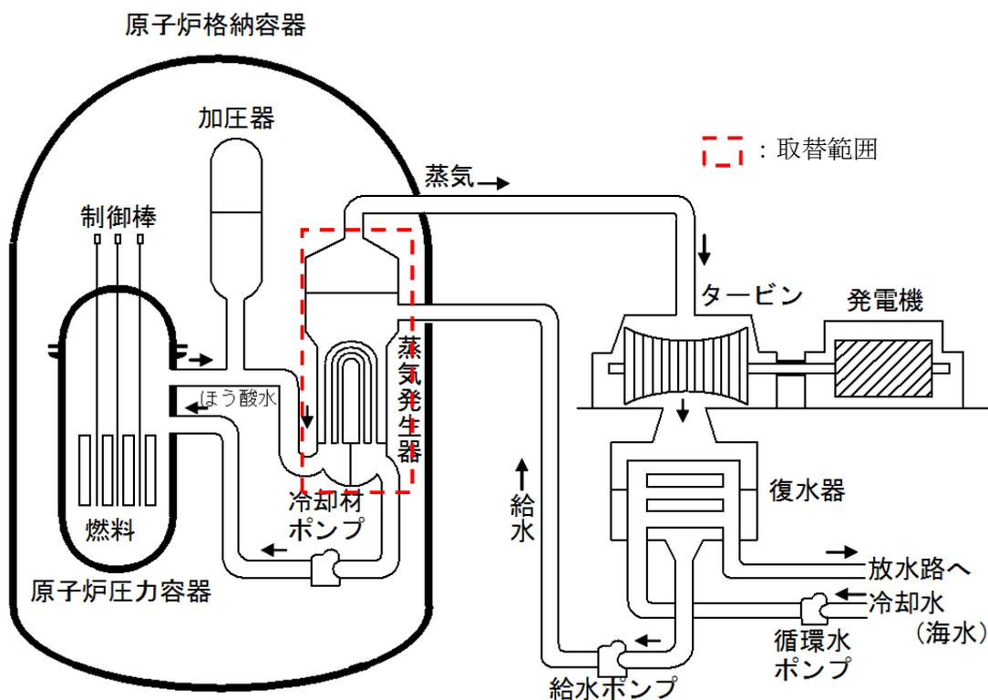
図 1 1 次冷却設備の構成の概要図
