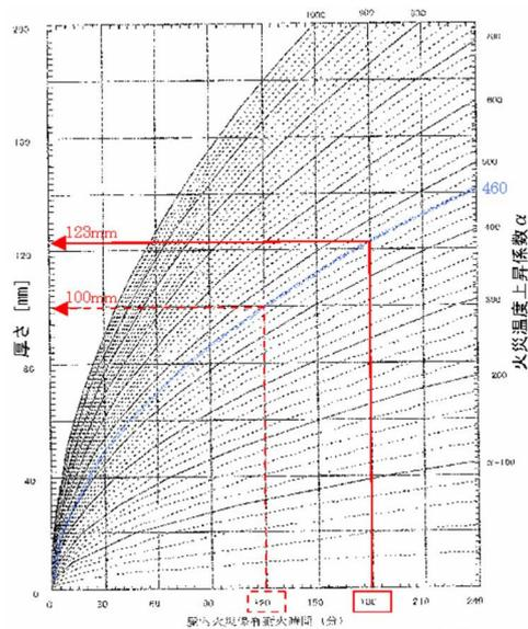
上式から求めた屋内火災保有耐火時間 180min（3 時間）に必要な壁厚は 123 mm となる。
