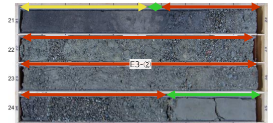
敷地3：層厚3mの海成礫を含むイベント堆積物
