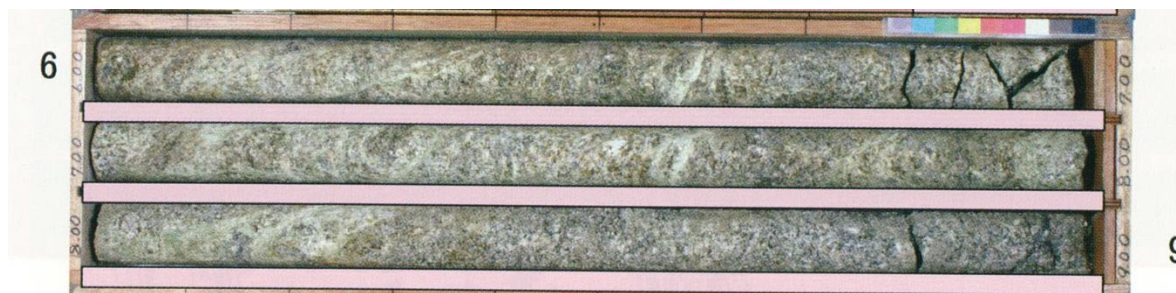
S22-1-2孔の深度6.1m～8.3m付近 花崗岩中に網目状の粘土を多く含む変質帯 宮下他(2011) ※上の図の赤枠のボーリング孔
