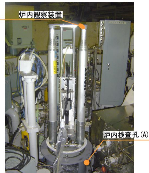
炉内検査孔 (A) からの観察
