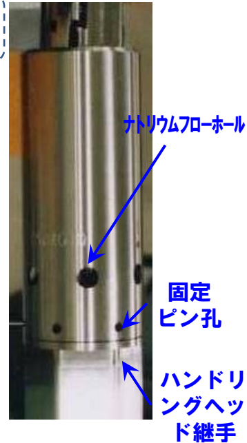
旧炉心上部機構引抜時に撮影したハンドリングヘッド（耐放射線性カメラによる撮影）
