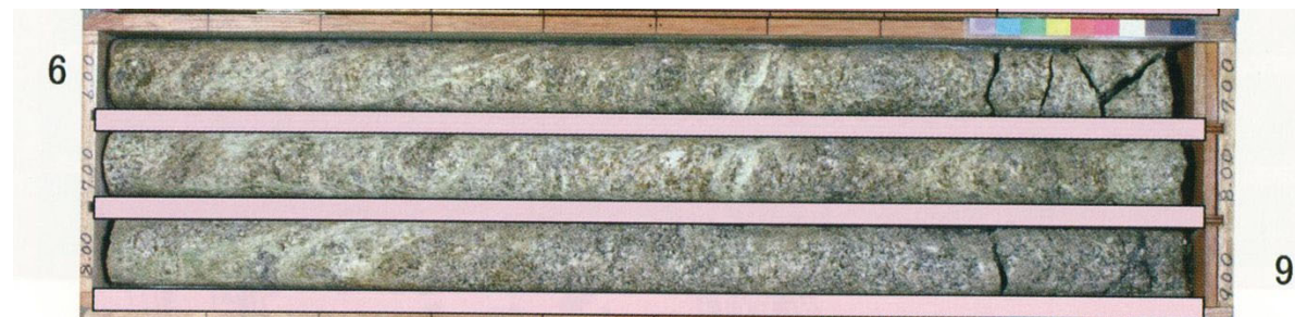
S22-1-2孔の深度6.1m~8.3m付近 花崗岩中に網目状の粘土を多く含む変質帯 宮下他(2011)
