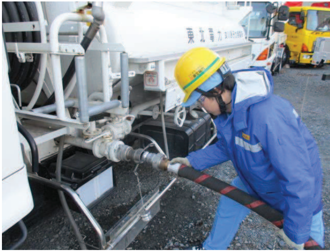
タンクローリへのホース接続
