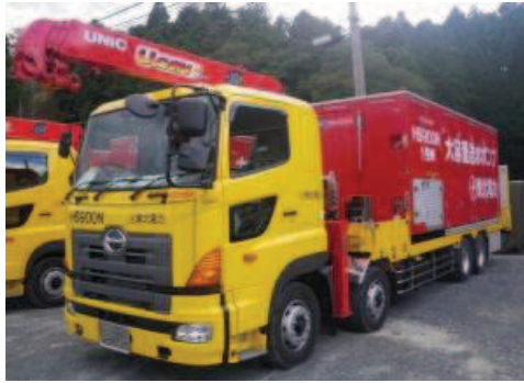
大容量送水ポンプ (タイプ I)
