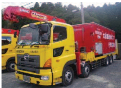
大容量送水ポンプ（タイプ I）
