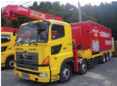
大容量送水ポンプ（タイプ I）
