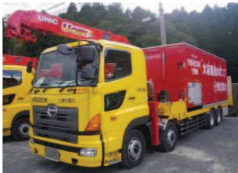
大容量送水ポンプ（タイプ I）
