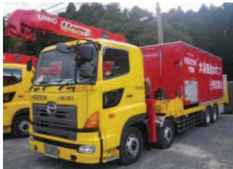
大容量送水ポンプ（タイプ I）
