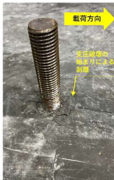
第 7-72 図 せん断試験後の状況写真（破壊形式確認ケース）
