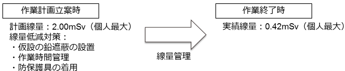
第19図 RCPインターナル除染作業での実績
