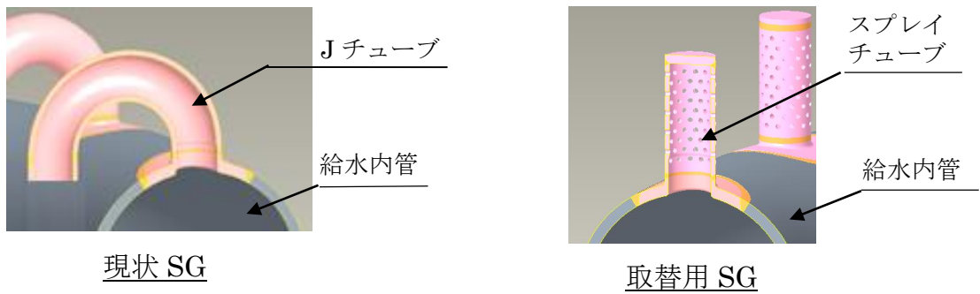
(c) 給水内管給水口
