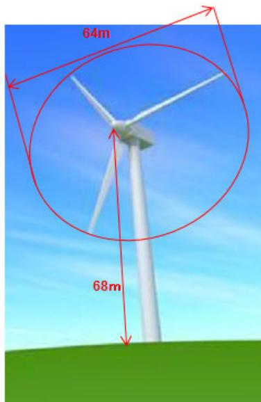
第2図 風力発電施設の概要図
