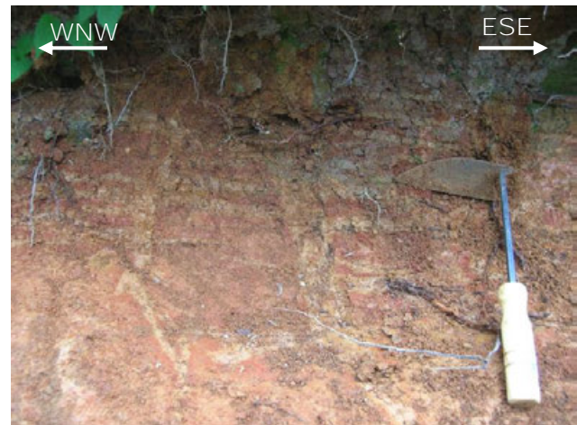
写真② 高位段丘 IV 面堆積層の土壌 赤褐色(2.5YR4/6)を呈するシルト質粘土からなり、斑紋状を呈する。
