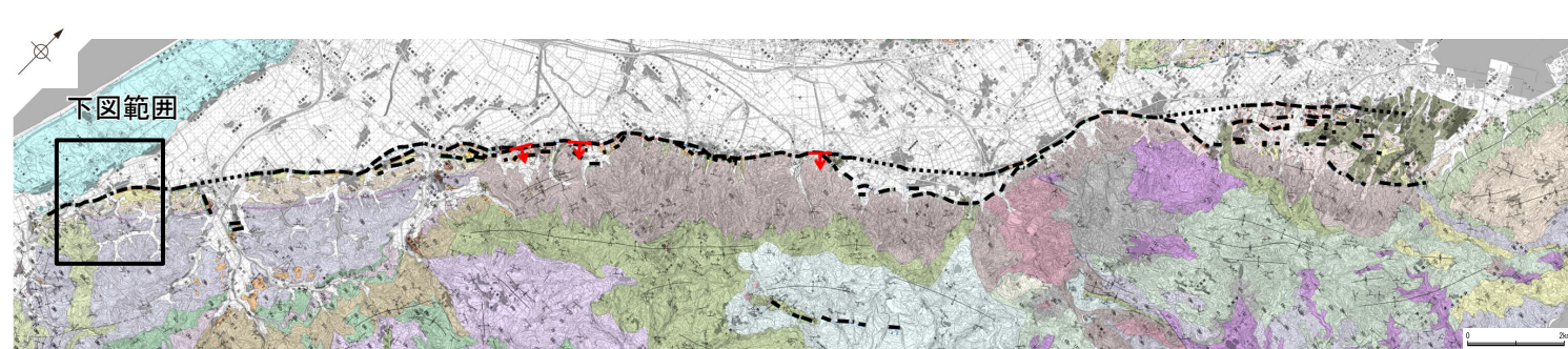
地質図 --- 断層位置 ..... 推定区間 ← 断層確認位置 【反射法地震探査】 — CMPライン — ステーションライン 120 CMP番号 80 ステーション番号
