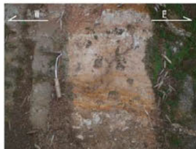
高階層 砂質シルト。層理面はほぼ水平 (N82° E/2° S)
