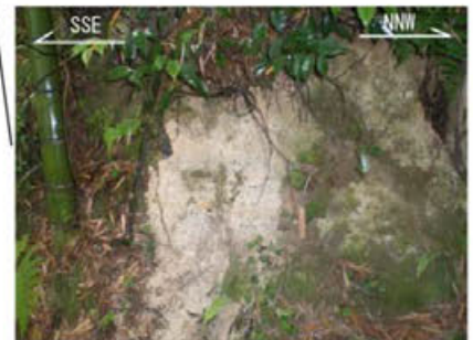
高階層 砂礫主体で砂を伴う。砂層の層理面はほ ぼ水平 (E-W/3° S)
