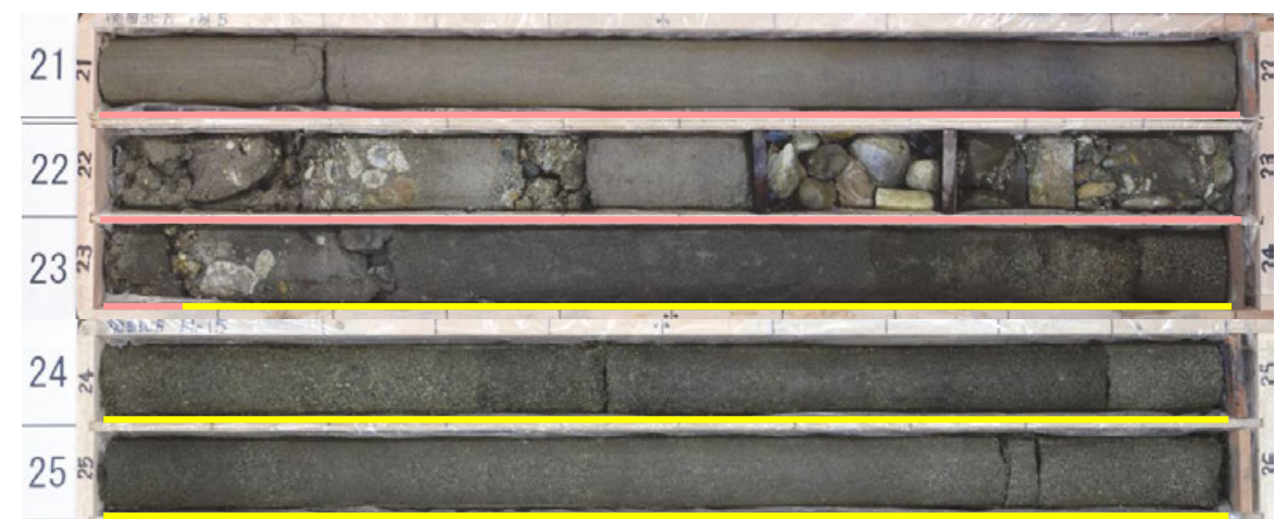
徳田北方No.5孔 コア写真(深度21～26m)
