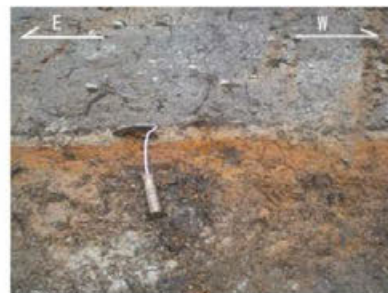
高階層 砂礫と泥の互層。ほぼ水平 (N5° E/3° E)。
