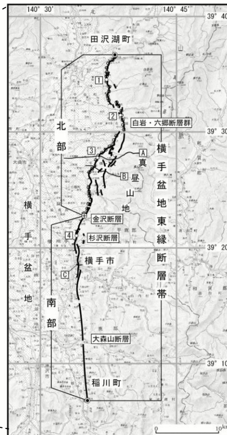
図2 横手盆地東縁断層帯の位置と主な調査地点 1: 十六沢地点 2: 金井伝地点 3: 一丈木・小森地点 4: 谷地中地点 A-C: 反射法弾性波探査測線 A: 文献1 B: 文献9 C: 文献2 ●: 断層帯の北端と南端 ⊕: 北部・南部の境界 ○: 1896年陸羽地震の地表地震断層 断層の位置は文献6及び8に基づく。 基図は国土地理院発行数値地図200000「秋田」「新庄」を使用。
