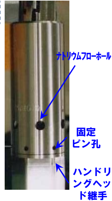
旧炉心上部機構引抜時に撮影したハンドリングヘッド（耐放射線カメラによる撮影）
