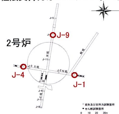
試掘坑内における支持力試験位置
