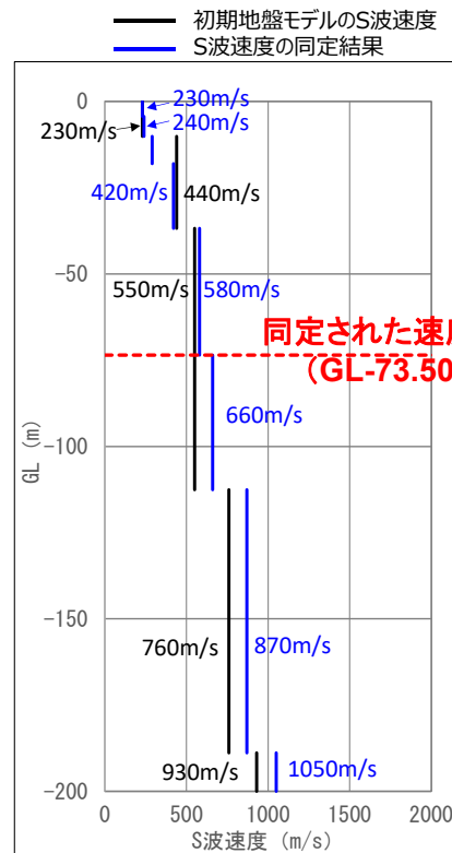
図9 S波速度及び速度境界の同定結果
