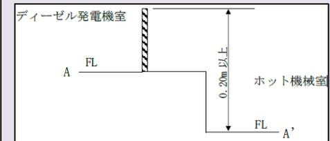
第2廃棄物処理棟 堰の嵩上げに係る概要図
