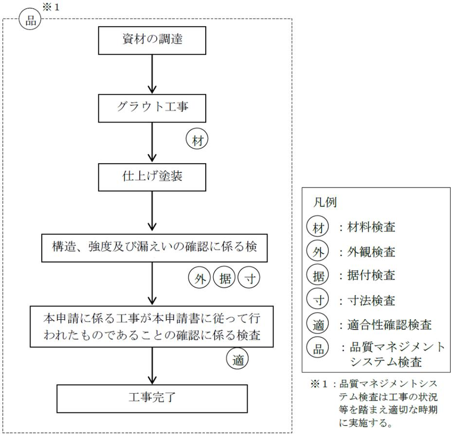
第3 廃棄物処理棟の蒸発処理装置・I 周囲に設ける堰の嵩上げに係る工事フロー図
