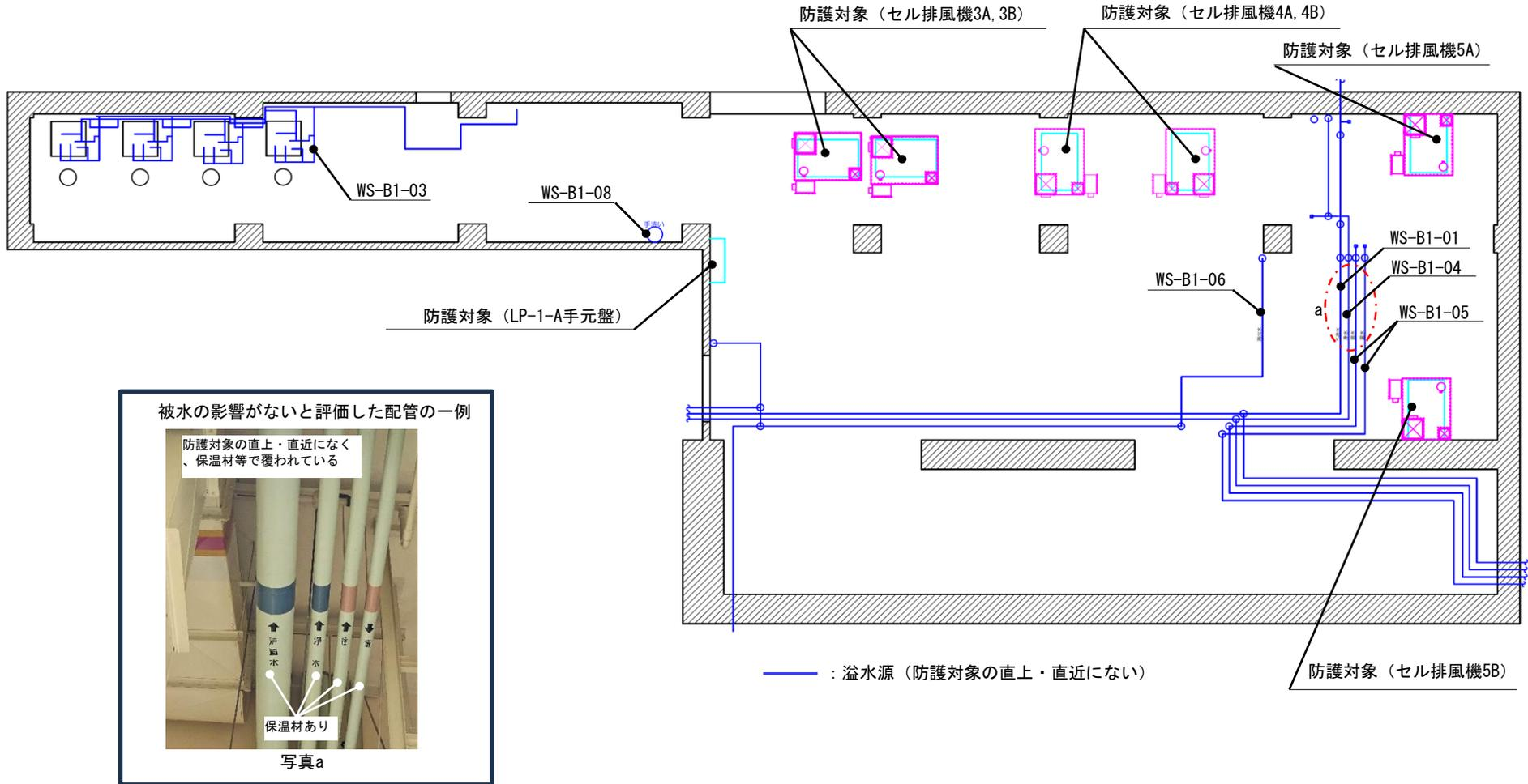
図2 溢水防護区画内の溢水源と被水の評価 (PA-B1F-1)
