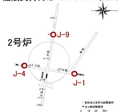
試掘坑内における支持力試験位置
