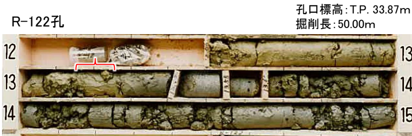
図(4).19 R-122孔コア写真 注2) R-122孔の孔径は66mmであり、他のボーリング孔の孔径(116mm)に比べて小さい。
